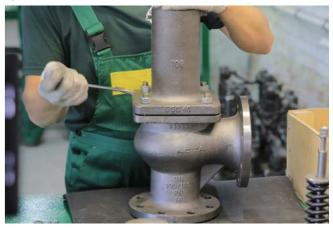
Изменение конструкторско-технологических параметров дает много плюсов: повышение прочности, стойкость к низким температурам окружающей среды, к термо- и гидроударам, а также возможность изготавливать корпуса для номинального давления в 25 бар.
