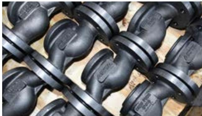
**7. Дополнительно мы можем окрашивать как корпуса, так и готовые регулирующие клапаны в цвета, выбранные заказчиком. Краска высокотемпературная, в зависимости от цвета держит температуру от  $400\text{ }^{\circ}\text{C}$  до  $550\text{ }^{\circ}\text{C}$ .**
