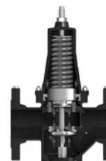
Клапан полностью закрыт (нет разбора).
