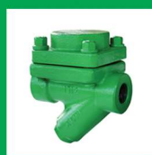
Конденсатоотводчик термодинамический АСТА ТД DN15-50, PN40 фланец/резьба
